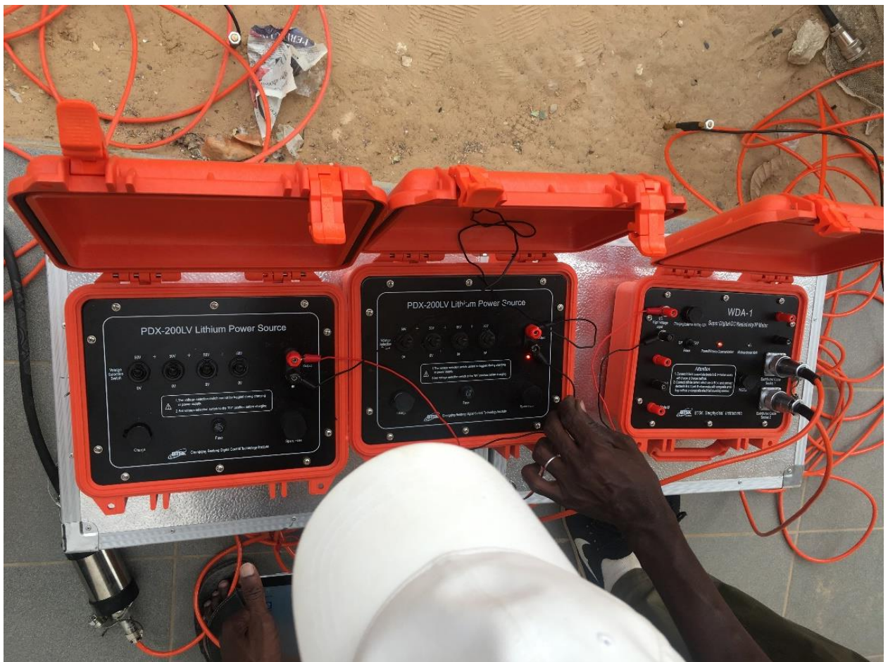
Figure 3 : Dispositif de mesure utilisé pour la réalisation de la tomographie de résistivité électrique (ERT).
